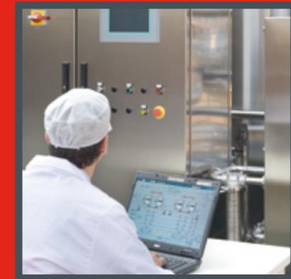
Automazione completamente controllata da PLC che comprende le operazioni di start up, svuotamento e lavaggio CIP, garantendo un notevole risparmio di mano d'opera. Il sistema è inoltre autoregolante ed ogni eventuale anomalia, mancanza prodotto ecc. viene visualizzata dal sistema. Pagine video dedicate per storico allarmi, trend, sinottici ecc. fanno parte integrante del Software.
