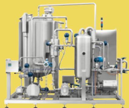
*Le système de dosage en ligne et en continu remplace le système de dosage conventionnel à batch, réduisant l'encombrement et éliminant les réservoirs de mélange classiques.*
