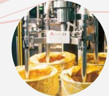
**(ES)** Sistemas de vaciado concentrados almacenados en aseptico o congelado (y compris las células y los morceaux de fruits), disponibles con bombas específicas para cada necesidad. Se puede integrar con unidades rompehielo. El sistema de gestión concentrados está provisto de tanques de almacenamiento térmicamente ajustados, con agitadores anti-estratificación, bombas y medidores para la dosificación en línea.
