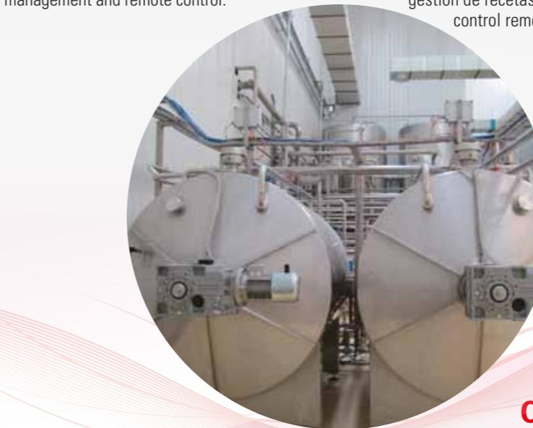
**(FR)** Un processus complet pour la réception, le mélange, la pasteurisation et le dosage des cellules, des morceaux et des pièces de fruits. Le système est constitué de réservoirs de mélange à axe vertical et / ou horizontal, équipés d'agitateurs spéciaux pour assurer l'uniformité de mélange et l'intégrité des cellules de fruits. Complet avec l'instrumentation pour le contrôle de tous les paramètres de processus, le logiciel pour la gestion des recettes et le contrôle à distance.
