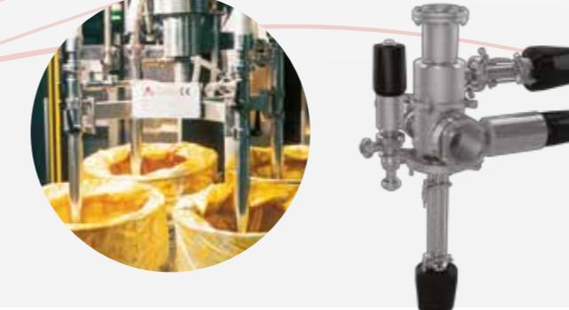
**(FR)** Des systèmes de réception, de vidange, de stockage et de dosage de concentrés aseptiques ou congelés (y compris les cellules et les morceaux de fruits). Intégrables avec des unités de brise-glace, des unités PIG, des réservoirs de stockage thermorégulés, des agitateurs anti-stratification, des pompes et des débitmètres pour le dosage en ligne.
