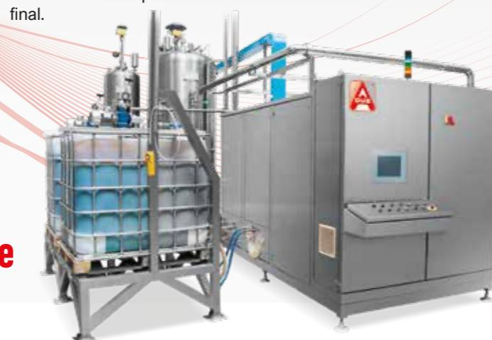
**(IT)** Une unité monobloc pour la préparation de sirop fini ou de boisson finie, par le dosage et le mélange in-line et in continuo, de 2 a 6 ingrédients. Gestion automatique des recettes et le contrôle automatique de tous les paramètres de travail. La variation de °Bx de sortie (production à régime)  $\sigma=0.02^{\circ}\text{Bx}$ . Recupero totale concentrati e prodotto finale.
